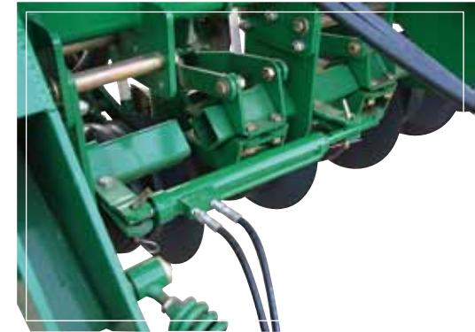
Tren de siembra delantero desplazable hidráulicamente.
