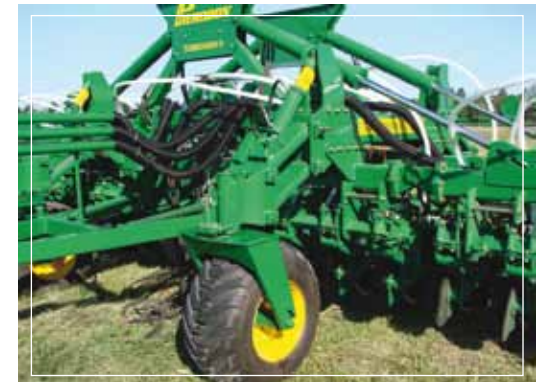
Balancín Hidráulico. El módulo central cuenta con 4 ruedas de mayor capacidad. Las dos ruedas delanteras solidarias hidráulicamente para formar un balancín que mejora la distribución de cargas en transporte.
