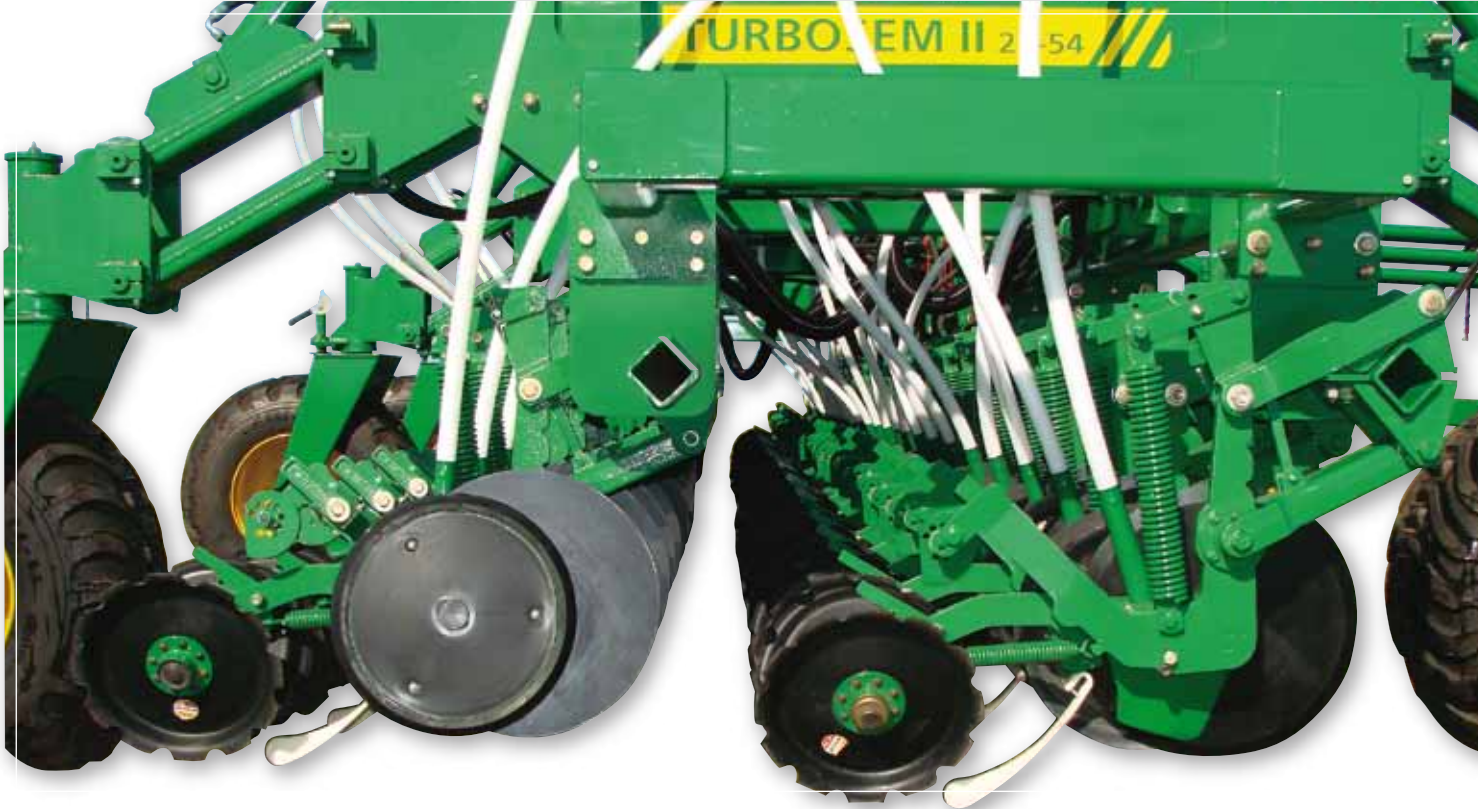
Tren de siembra delantero desplazable hidráulicamente.
