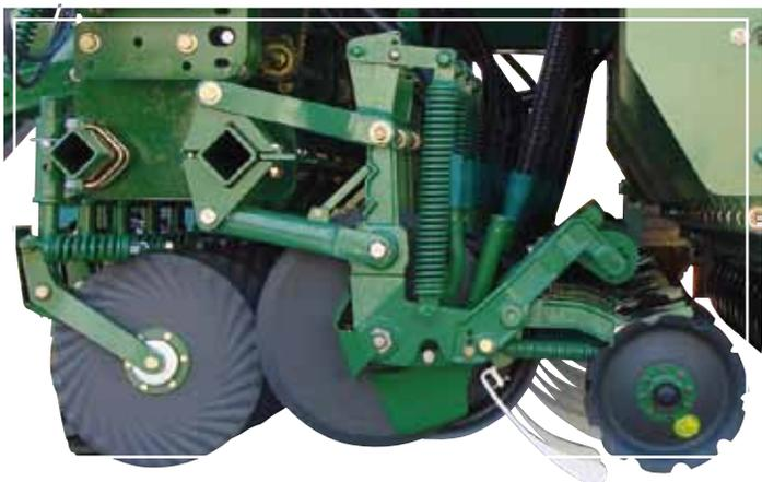
Disco Integral Simple de 17.3/4" y zapata, rueda reguladora de profundidad, patín afirmador de semillas y conjunto de discos tapadores conformadores dentados. Línea unida al chasis con paralelogramos.
