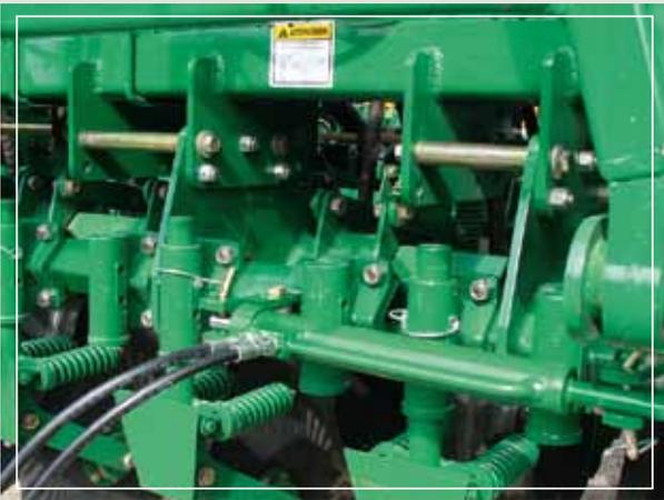
**Barra porta cuerpos delantera** con posibilidad de desplazarla, para siembra de granos finos y doble fertilización en granos gruesos, evitando correr los cuerpos individualmente. Para esta operación se provee un cilindro hidráulico con bomba manual.
