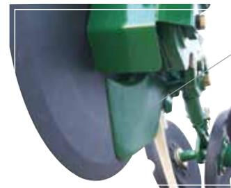
Zapata con tratamiento de dureza y sistema de flotación que le permite estar siempre en contacto con el disco. **Patente de Invención ARO02802B1.** Los tubos de bajada semilla - fertilizante son independientes.
