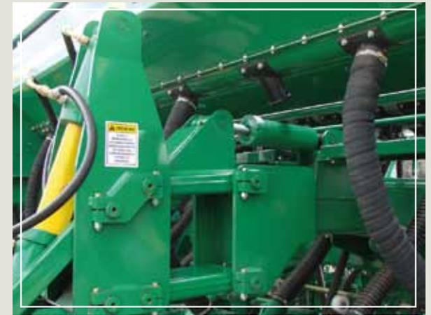
**Sistema de balancín hidráulico** independiente al levante, para repartir las cargas sobre las 4 ruedas, tanto en trabajo como en transporte.
