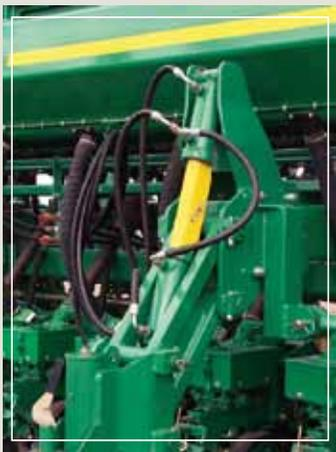
**Cilindros hidráulicos** de doble carrera para lograr dos posiciones de despeje, una para trabajo y otra mayor para transporte.
