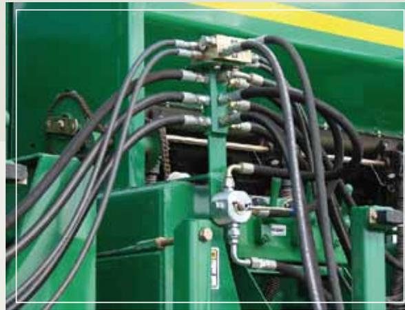
**Válvula general:** para operaciones de levante simple, levante doble en traslado y nivelación del balancín hidráulico (en caso de contar con dicho elemento).
