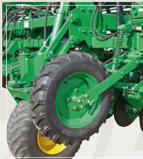
**Transmisión por rueda motriz con presión registrable**, asegurando que dicha rueda esté siempre en contacto con el suelo.
