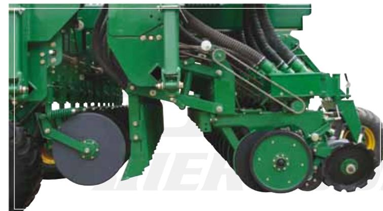
Cuchilla lisa de 18" de diámetro y herramienta para fertilización profunda en línea, con sistema de balancín paralelogramo, el cual permite que la entrada de la herramienta se realice después que el cuerpo de siembra haya tomado contacto con el suelo, de esta manera se reduce la posibilidad que quede rastrojo sin cortar entre la cuchilla y la herramienta.
