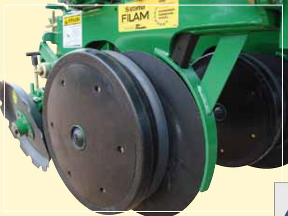
Discos con estampado cónico y filo interno, permanecen en contacto continuo durante toda su vida útil. El estampado cónico en la periferia hace que el ángulo de ataque sea menor, disminuyendo la resistencia al avance y la penetración.
