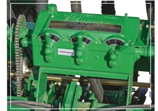
Transmisión por rueda motriz que evita los sistemas de embrague. Con registro de presión, asegurando que dicha rueda esté siempre en contacto con el suelo para una tracción perfecta.
